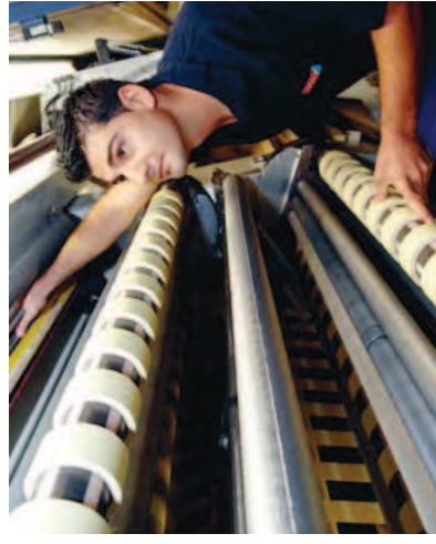
Alli Yilmaz überprüft die fertig geschnittenen Bänder, bevor sie über Wickelwellen auf die Rollenkerne gesputet werden.
